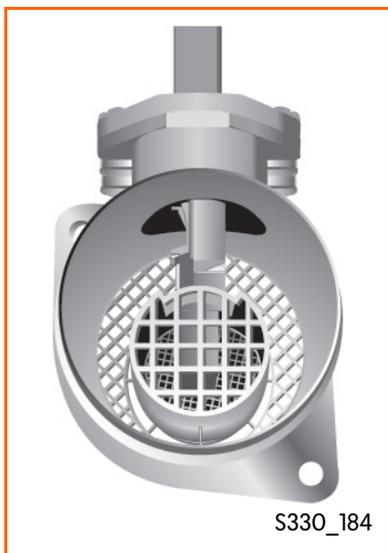
Le débitmètre d'air massique à film chaud est monté dans le canal d'admission. Le débitmètre d'air massique permet au calculateur moteur de déterminer la masse d'air réellement admise.
